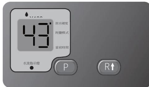
圖14 原水硬度設置
