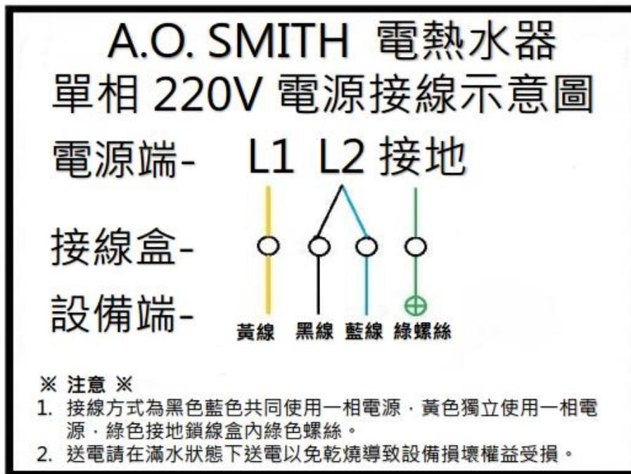
**注意：**本圖只用於 ECT/ECS(6kw)電熱水器，額定電壓 220V 下，對應的額定電流為 27A，需配接的銅芯電源線的最小截面積為 6mm<sup>2</sup>。
